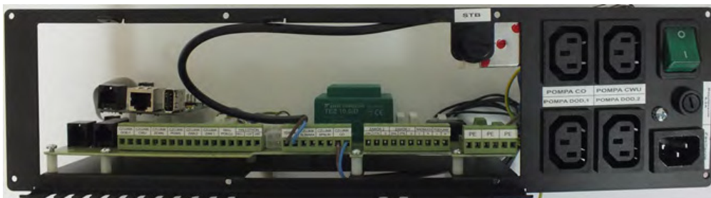
Rysunek 2. Listwa przyłączeniowa do zasilania urządzeń regulacyjnych
